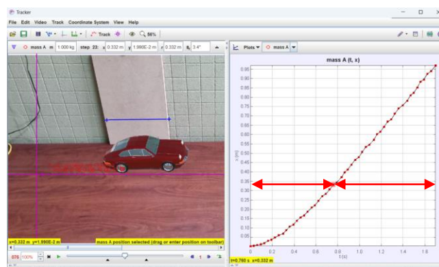
Figura 4. Gráfica de posición-tiempo realizada en el software Tracker. En la gráfica se representa en forma aproximada donde cambia de MRUV a MRU. En azul se muestra la distancia de 0.30m utilizada como referencia de longitud.
